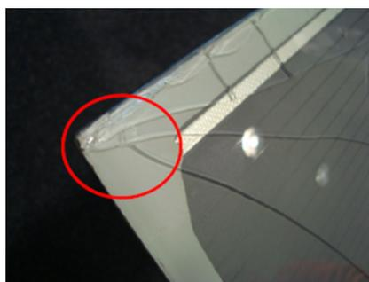
**Figura 19** Ejemplo de patrón de rotura típico de los módulos de First Solar
