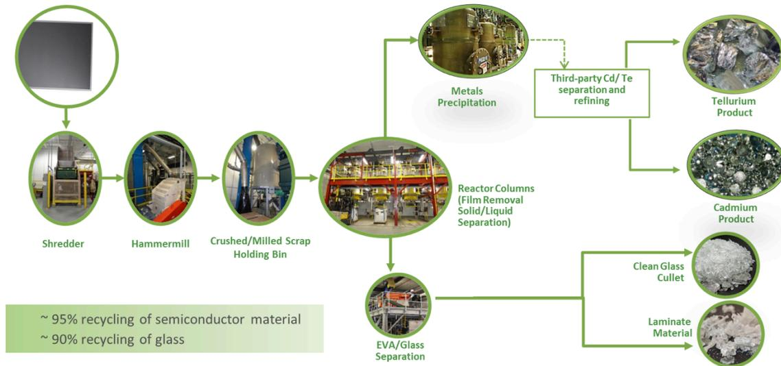
Figura 4 Versión 2 de la tecnología de reciclaje de módulos de First Solar
