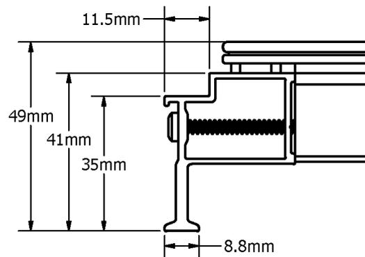
Figure 2: Long Edge Frame Detail
